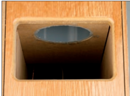
Graphican pitkän refleksikanavan ulkopäässä on vaimennettu putki, jonka tarkoitus on resonanssin poistaminen.
